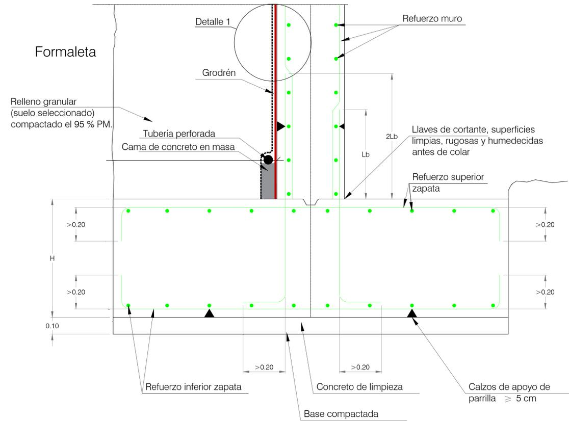
**ARRANQUE DE MURO EN ZAPATA CORRIDA CENTRADA**
