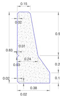
**SECCION ARMADO NEW JERSEY BORDE DER.-IZQUI.**
